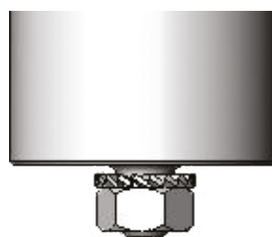
Fijación a través de tornillo M12 (tuerca y arandela dentada incluidas en la UCWT)
